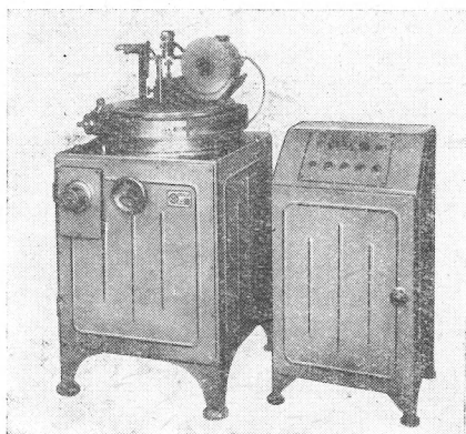
Рис. 16-12. Станок для двусторонней шлифовки.
