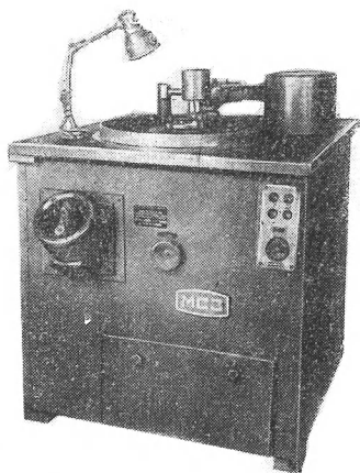
Рис. 16-6. Станок для односторонней шлифовки свободным абразивом с вращающимся шлифовальником и качающейся шайбой.
